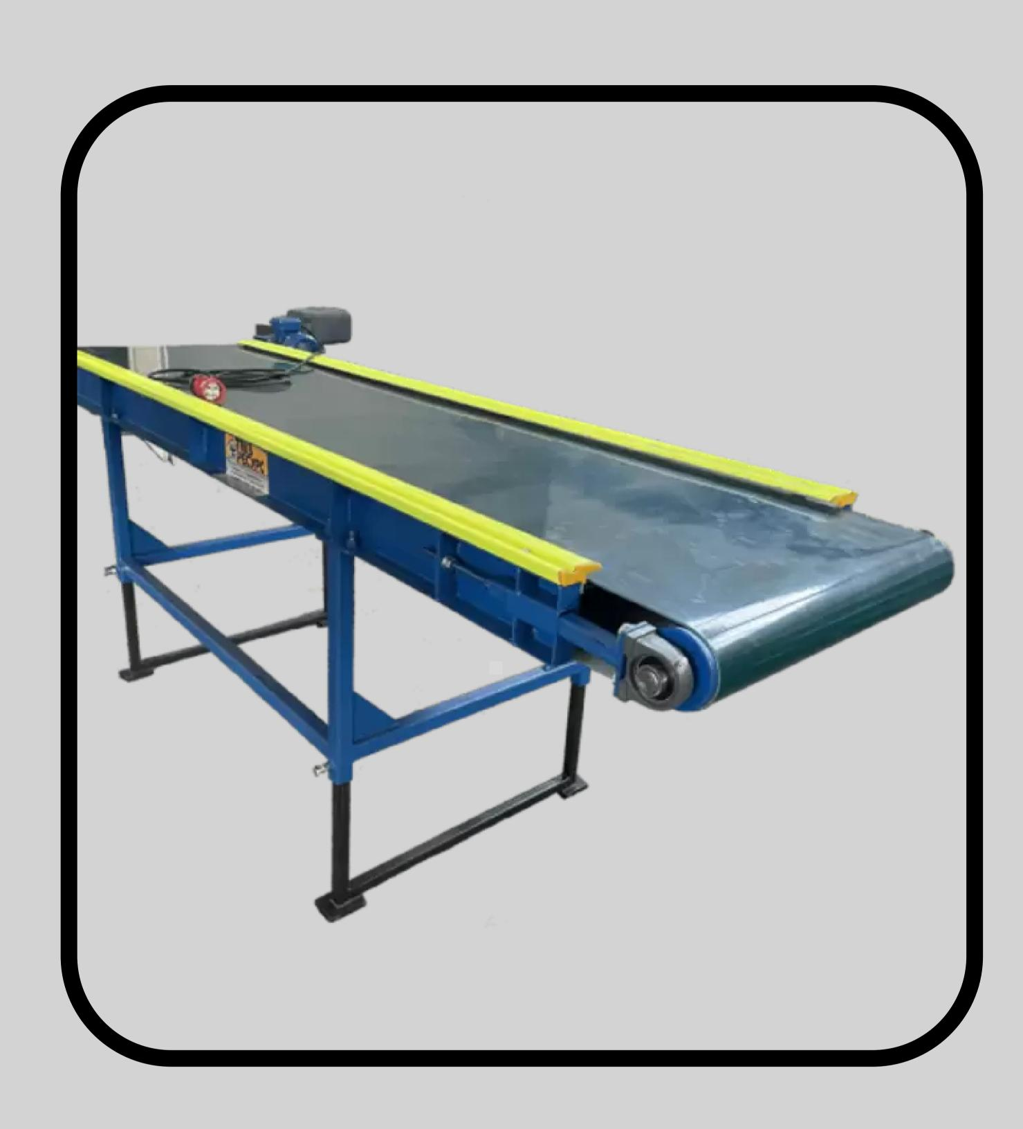
СТОЛ ИНСПЕКЦИОННЫЙ (МОДУЛЬ ОЧИСТКИ/ СОРТИРОВКИ СЕРИИ «ОП»)
