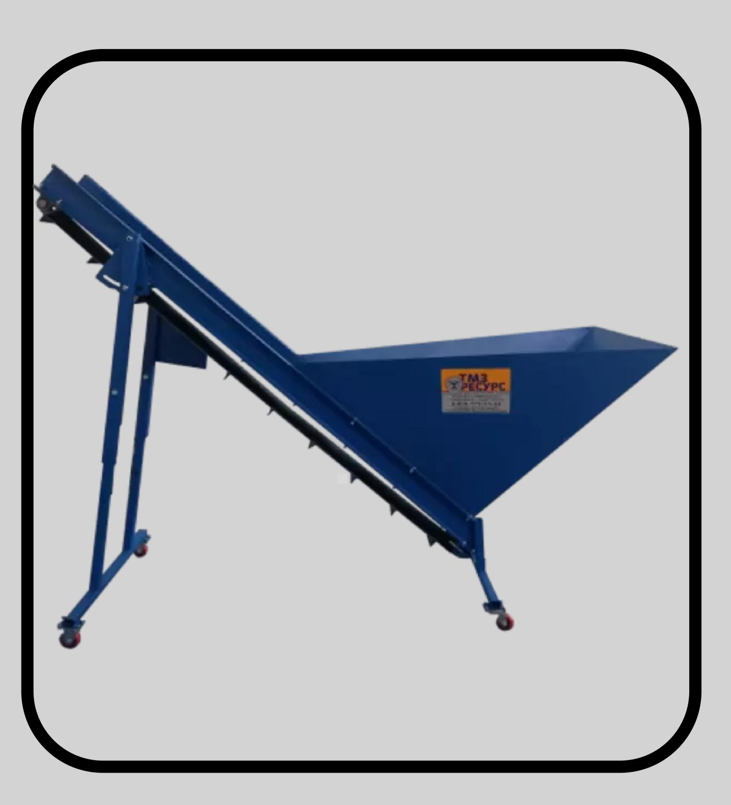
ПОДАЧИ МАЛЫЙ (ПЕРЕГРУЗОЧНЫЙ КОНВЕЙЕР ТРАНСПОРТЕР С ПРИЕМНЫМ БУНКЕРОМ) Конвейеры подачи с бункерами являются вспомогательными механизмами, ОНИ облегчают подъем/подачу чеснока сборных емкостей (Биг-Бэгов, первичных пластиковых/деревянных овощных мешков) на линии дальнейшей переработки (линии очистки, линии дробления, сортировки и пр.). меняют Они высоту, скорость подачи передвигаются материала, легко ПО производственным помещениям.
